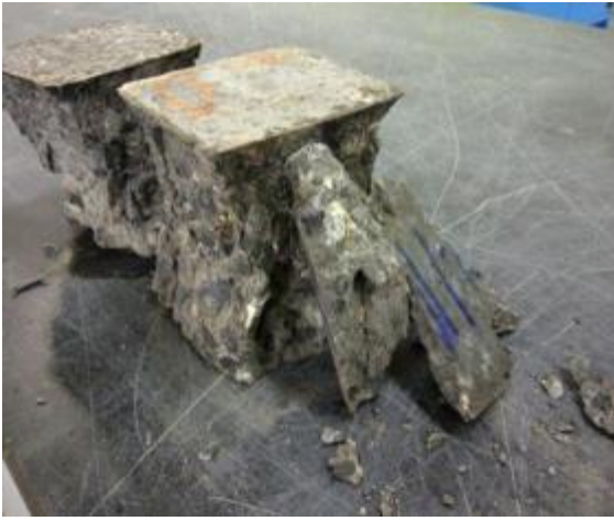
Imagen 9 Forma de falla del concreto después de siete días para todos los especímenes (Al Ajmani, Suleiman, Abuzayed, & Tamimi, 2019).
