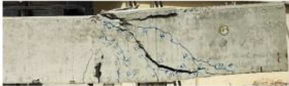
e) Viga con agregado natural reforzada con fibras de vidrio
