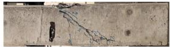
d) Viga con agregado reciclado con estribos
