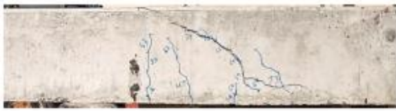
a) Viga con agregado natural sin estribos
