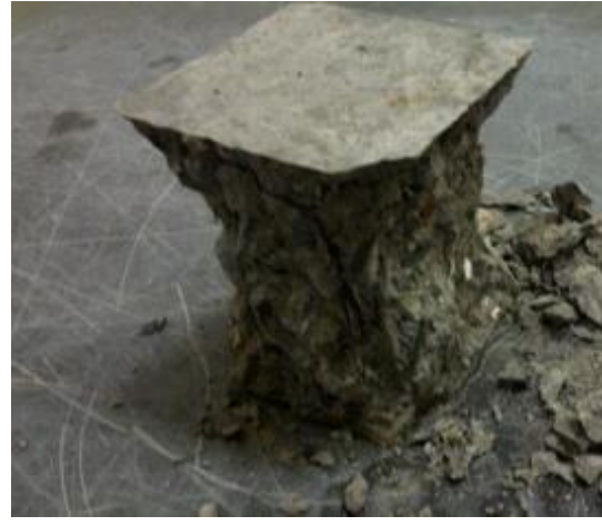
Imagen 10 Forma de falla del concreto después de 56 días para todos los especímenes (Al Ajmani, Suleiman, Abuzayed, & Tamimi, 2019).
