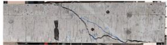
f) Viga con agregado reciclado reforzada con fibras de vidrio
