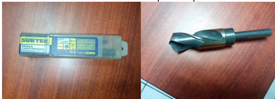
Ilustración 53. Broca utilizada para las perforaciones.
