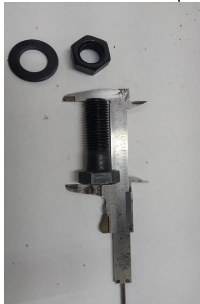
Ilustración 18. Tornillos utilizados para uniones.
