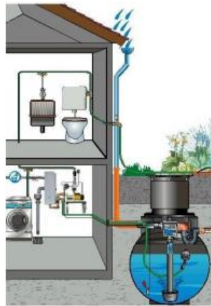
Figura 5. Sistema automatizado de cosecha de agua pluvial.
