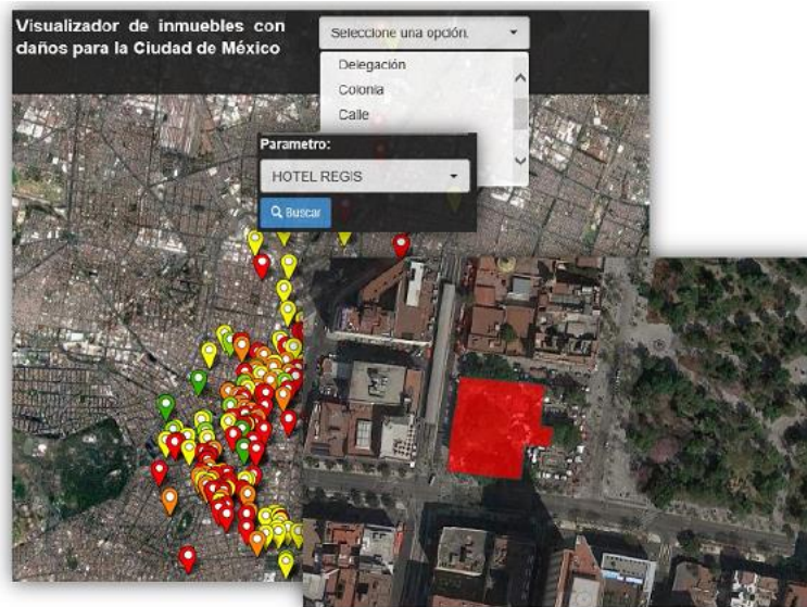
Figura 1.5 Herramienta de búsqueda de edificaciones dañadas, la consulta se realiza mediante los diferentes parámetros o atributos que identifican al inmueble. Buendía y Reynoso (2019) 7
