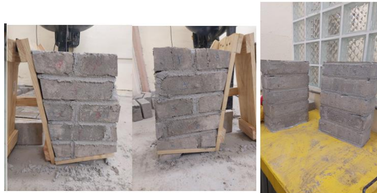
Figura 1.27 Muestras de probetas fabricadas para determinación de falla a compresión 28
