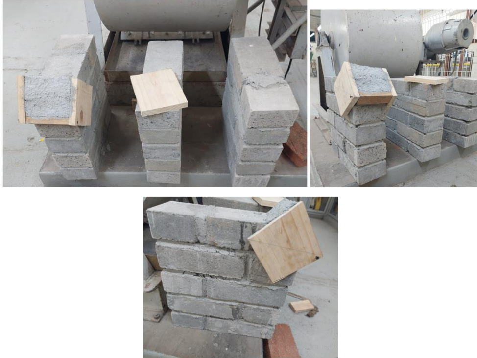
Figura 1.26 Muestras de probetas fabricadas para determinación de falla a tensión diagonal 27
