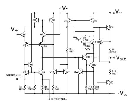
Su símbolo es un triángulo. En su base hay conectadas dos entradas, V<sub>+</sub> (**no inversora**) y V<sub>-</sub> (**inversora**), que corresponden a las patillas números 3 y 2 respectivamente. La señal de salida, *V<sub>out</sub>*, se localiza en la patilla 6.
