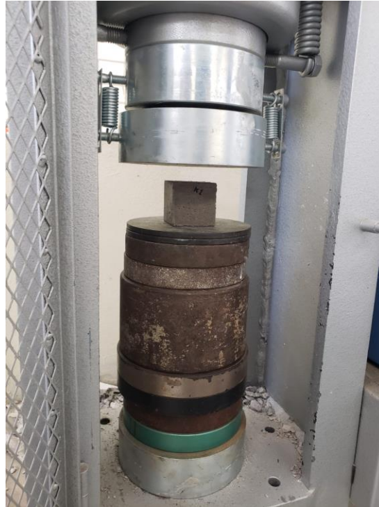
Ilustración 24. Evaluación de la resistencia a la compresión del mortero.
