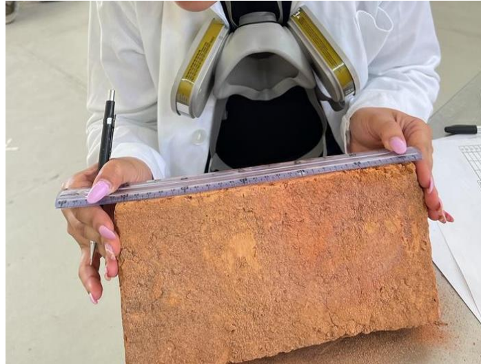
Ilustración 18. Determinación de las dimensiones de los especímenes de ensayo.
