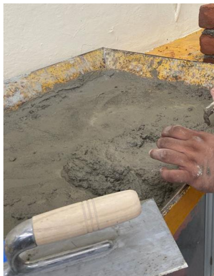
Ilustración 26. Elaboración de mortero Tipo II para elaboración de pilas de tabiques.
