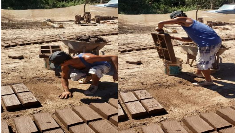
Ilustración 11. Proceso de elaboración de tabique.
