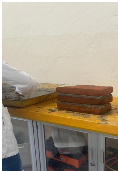
Ilustración 22. Elaboración de las pilas de ensayo.
