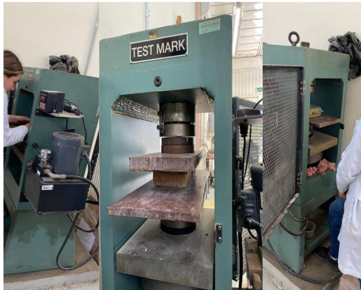
Ilustración 20. Máquina de ensayo para prueba de resistencia a la compresión.
