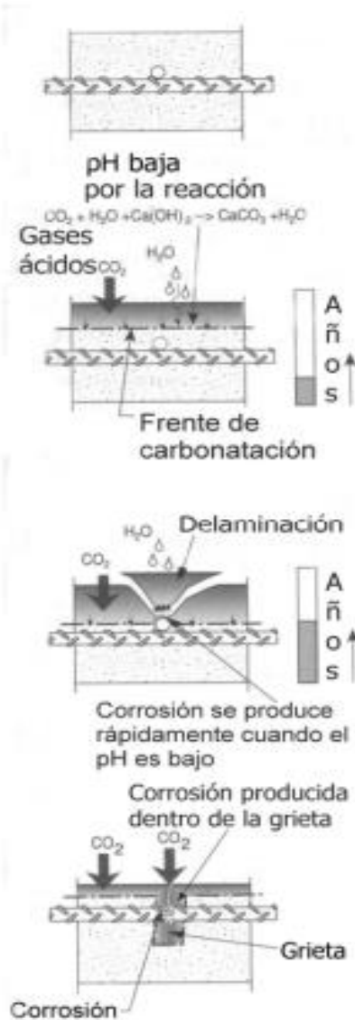
Figura 11. Esquema de deterioro causado por la carbonatación
