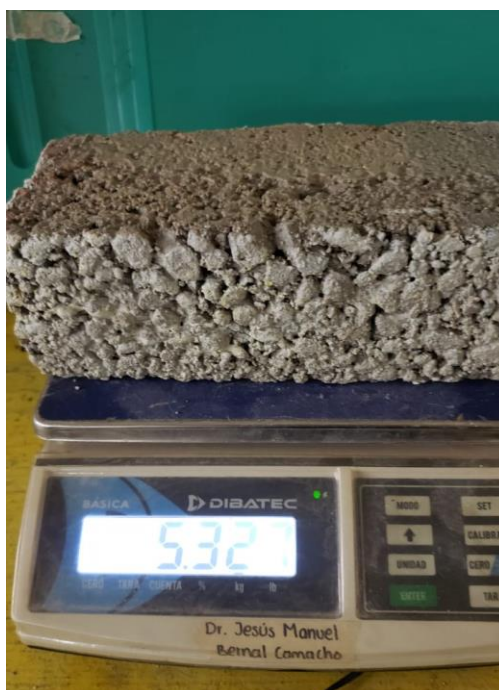
Ilustración 29. Determinación de la masa de pieza de fabricante B.
