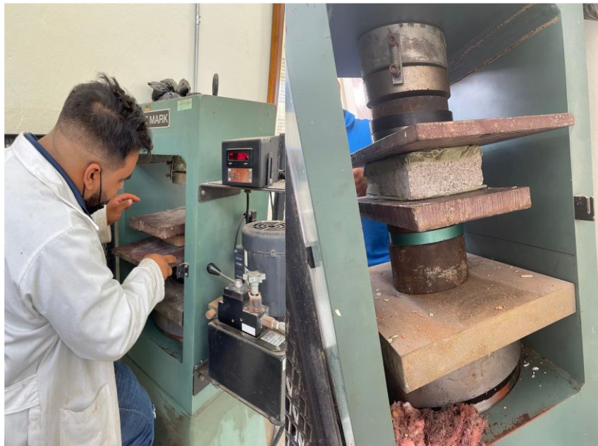
Ilustración 24. Máquina de ensayo para prueba de resistencia a la compresión.
