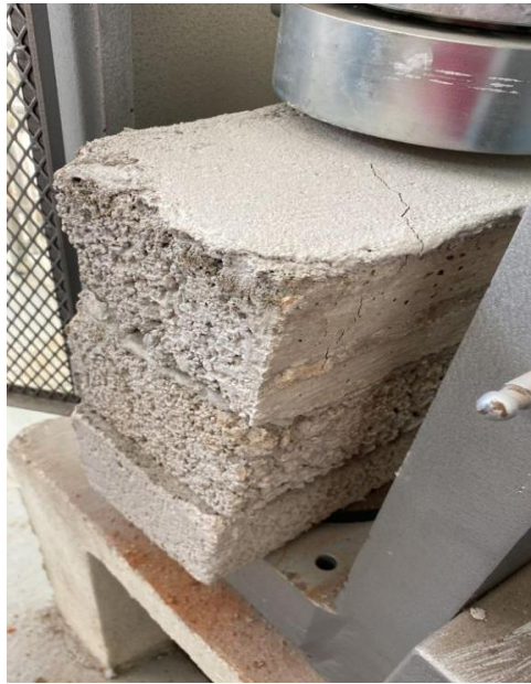
Ilustración 32. Prueba de resistencia a la compresión en pilas.
