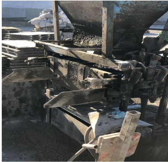
Ilustración 17. Tolva dosificadora y premoldeado por vibro compresión.
