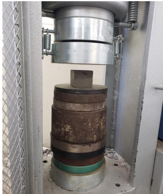
Ilustración 28. Evaluación de la resistencia a la compresión del mortero.
