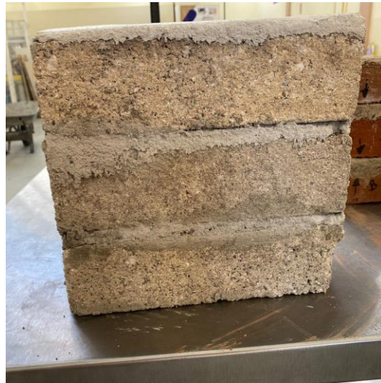
Ilustración 26. Elaboración de las pilas de ensayo.
