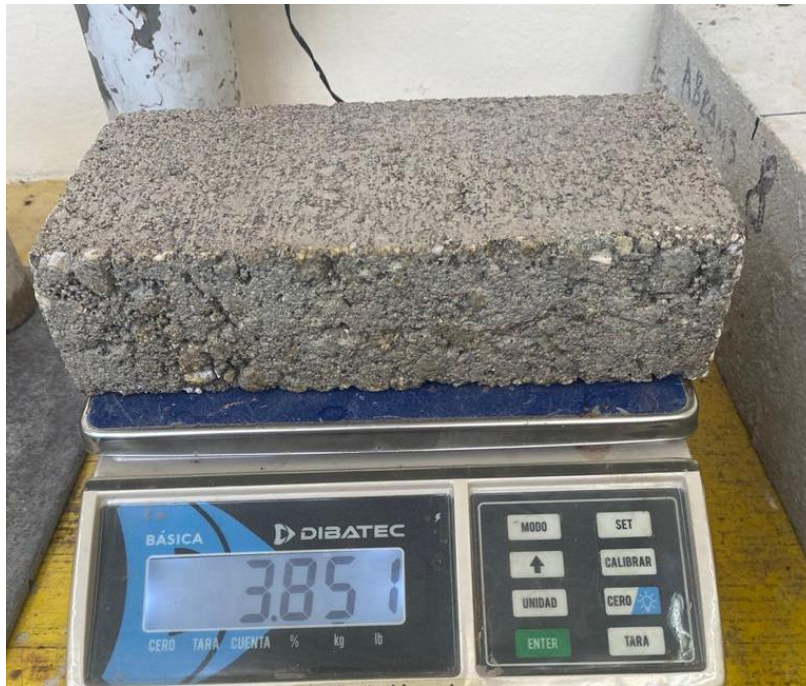
Ilustración 20. Medición de la masa del tabicón ligero.
