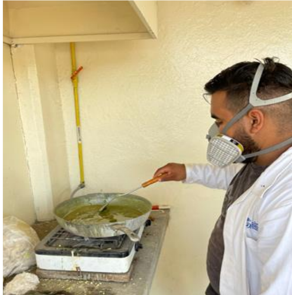
Ilustración 22. Fundición de azufre para cabeceo de espécimen.
