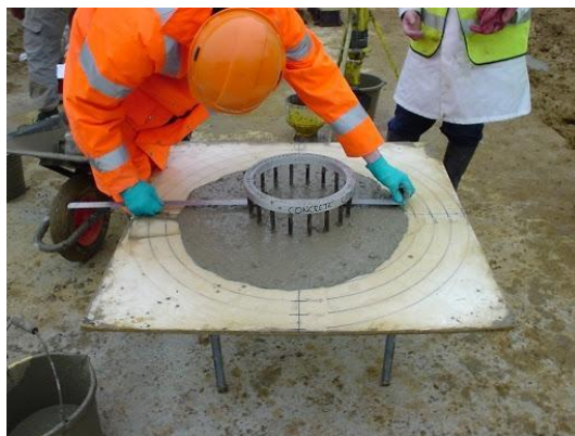
Figura 2. Ensayo en anillo J. Fuente: Estudio Sassani, disponible en: https://estudiosassani.wordpress.com/2021/04/06/ensayo-de-anillo-j-hormigon-armado/
