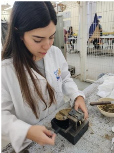
Ilustración 41. Accionado de manivela de la copa
