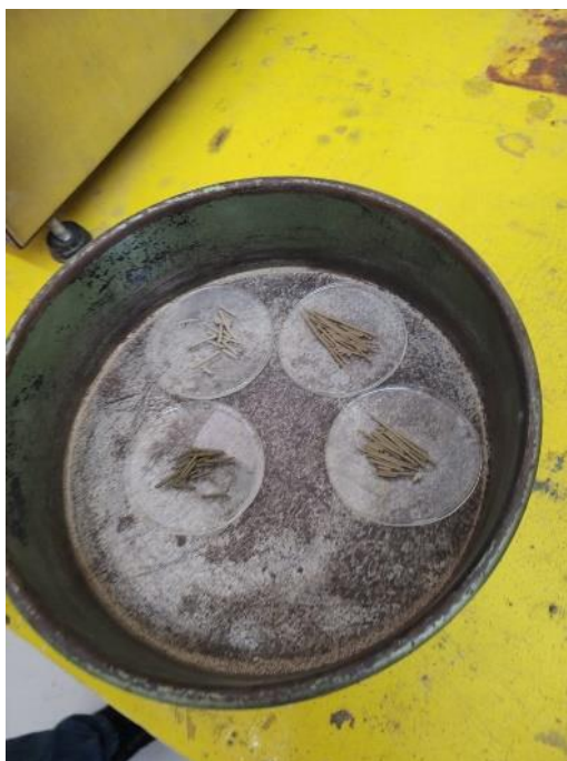
Ilustración 45. Cilindros realizados para limite plástico
