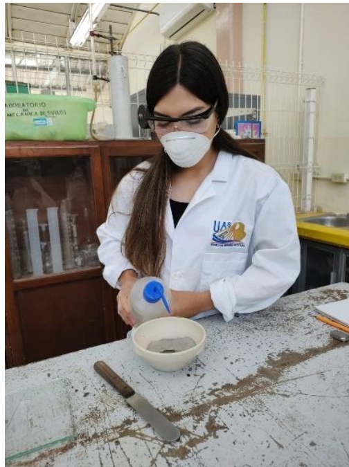
Ilustración 39. Saturación del suelo con agua destilada
