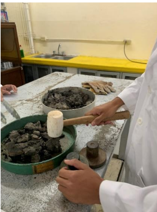
Ilustración 31. Cuarteo de la muestra
