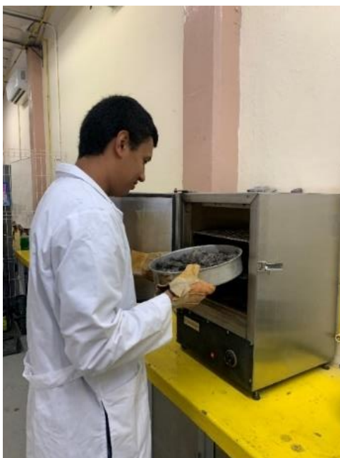
Ilustración 30. Sacado de la muestra del horno después de 24hrs
