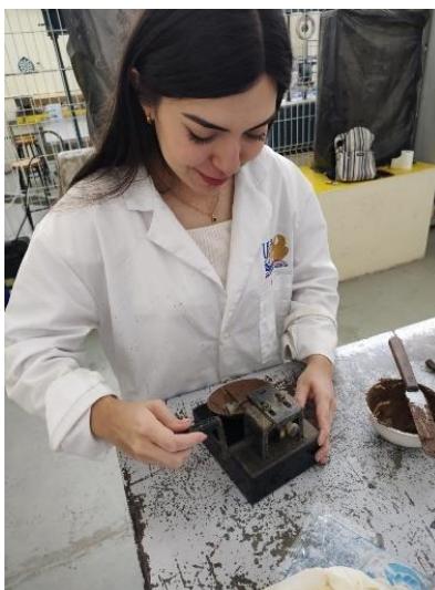
Ilustración 20. Accionado de manivela de la copa
