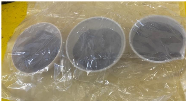
Ilustración 23. Reposo de las muestras con su dosificación de cal
