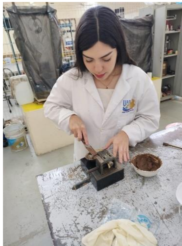
Ilustración 19. Material extendido en copa
