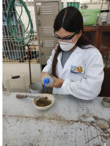
Ilustración 24. Saturado del suelo con cal
