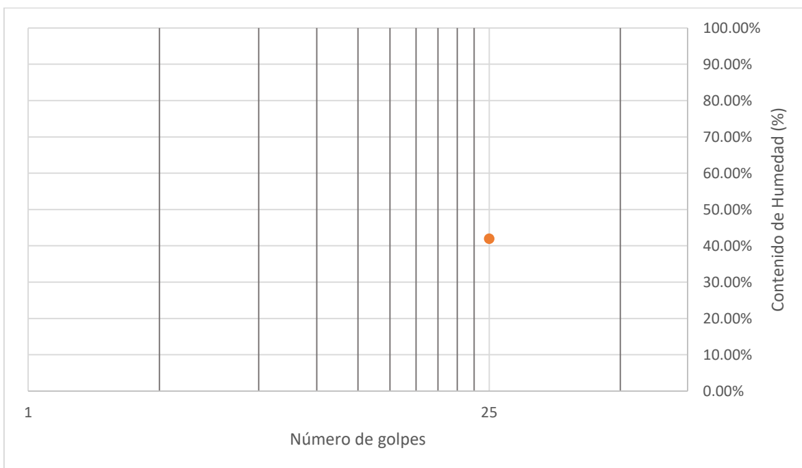
Gráfica 11. Determinación de límite líquido de la muestra 3 con 6% de cal
