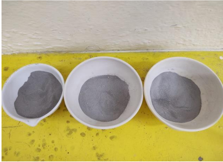
Ilustración 38. Mezcla homogénea del suelo con la cal
