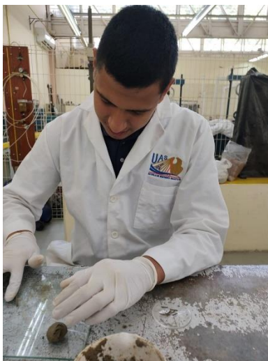
Ilustración 27. Cilindros de muestra con cal realizados sobre placa de vidrio
