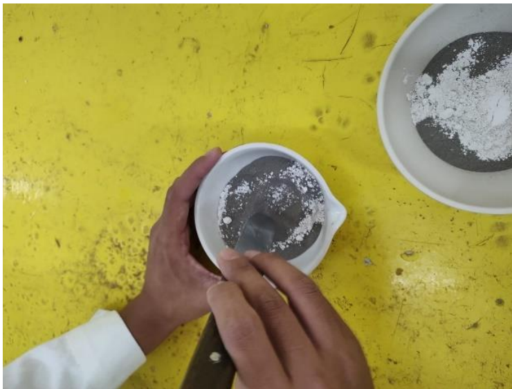
Ilustración 37. Mezclado de cal con el suelo
