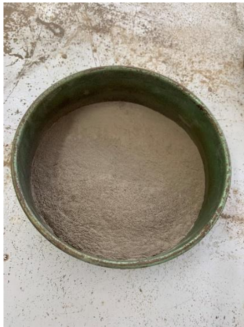
Ilustración 33. Material que pasó por la malla no. 40
