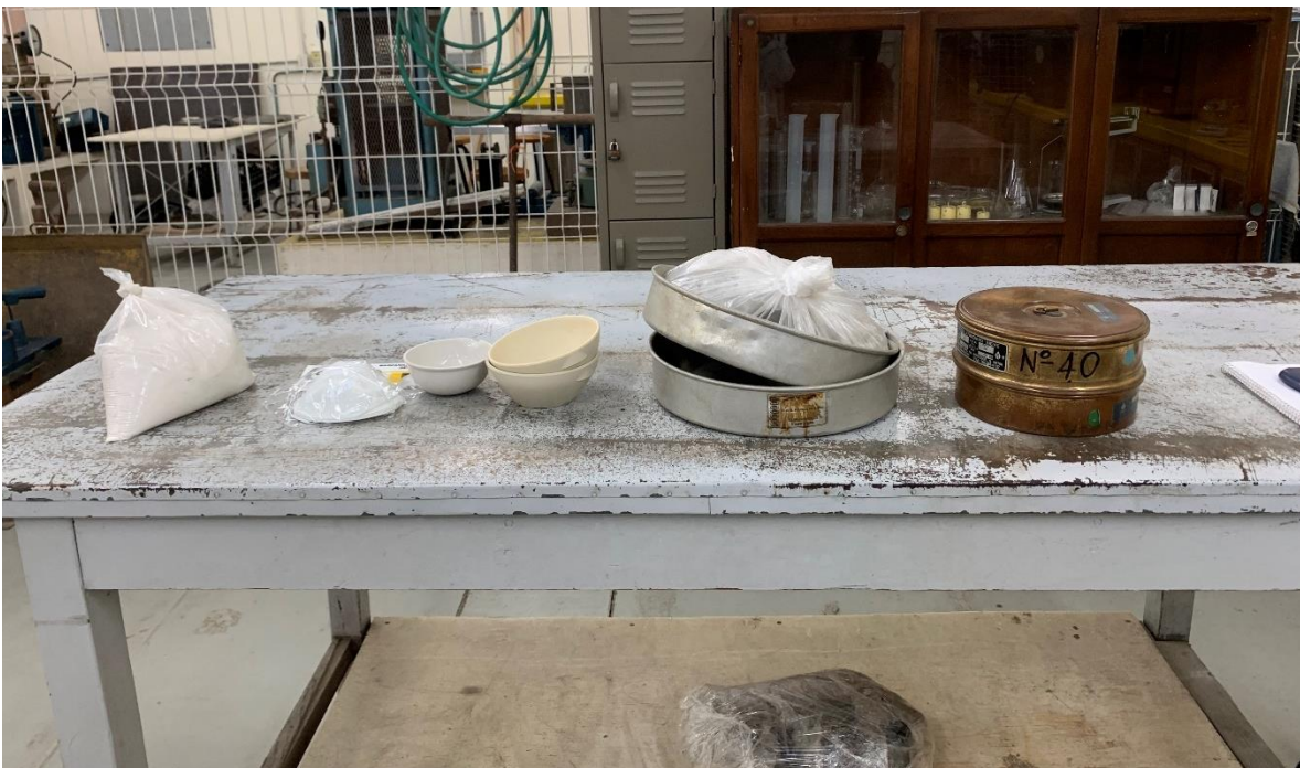
Ilustración 35. Equipo y material para realizar los límites de Atterberg con cal
